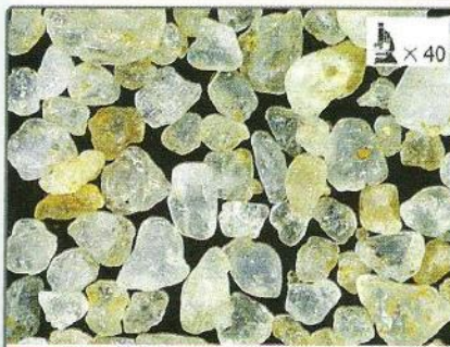
Figure. a : Aspect des grains de sable non transportés ou ayant subi un faible transport : grains Non Usés (NU) .
